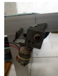
Figure 15. Hasil Motor DC pada Bagian Samping Luar Konveyor
