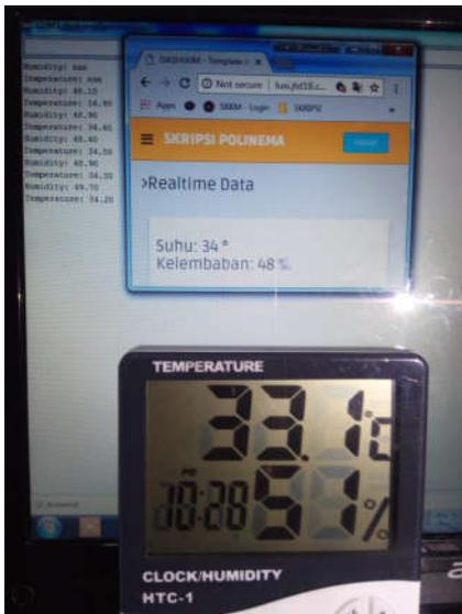
**Gambar 4.1** Pengujian Sensor Dengan Alat Ukur Hygrometer di Siang Hari
