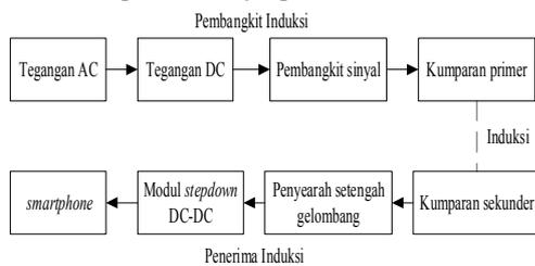
Gambar 8. Diagram cara kerja sistem
