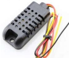
Gambar 2. Sensor Suhu DHT21
