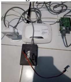
Gambar 8 Hasil Implementasi Alat Deteksi Getaran
